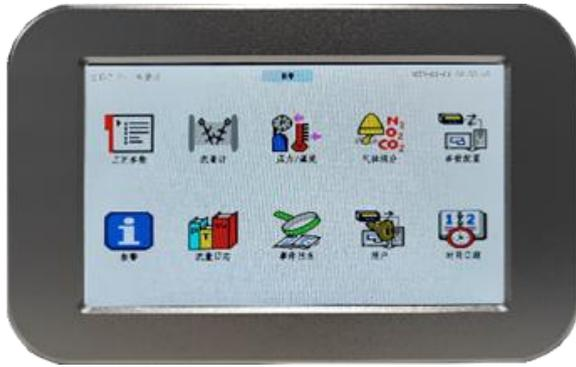
**Thinkin SmartFC-M7 通用型流量计算机**是一种高性能流量计算机，可以使气体检测达到采用涡轮流量计、超声波流量计、腰轮流量计或孔板流量计中的任何一种流量计所能达到的高精度。SmartFC-M7 允许用户对其进行灵活配置，以达到操作要求。
